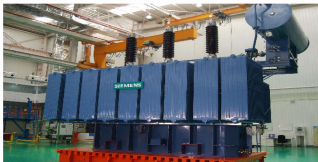
FSC, 俄羅斯 150MVA/220 Type 3XCM2
